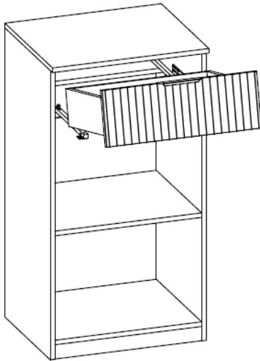
1. При установке ящика скобы выдвижных механизмов введите в отверстия на задней стенке ящика.
