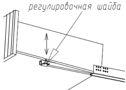
4. При желании, закрепите ящик к направляющим саморезами. ВАЖНО! Во избежание повреждения боковины ящика рекомендуется предварительно просверлить отверстие для вкручивания самореза.
